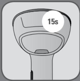
**ES** Espere durante al menos 15 segundos antes de presionar el botón de vapor. La luz indica que el elemento calefactor está en funcionamiento.
